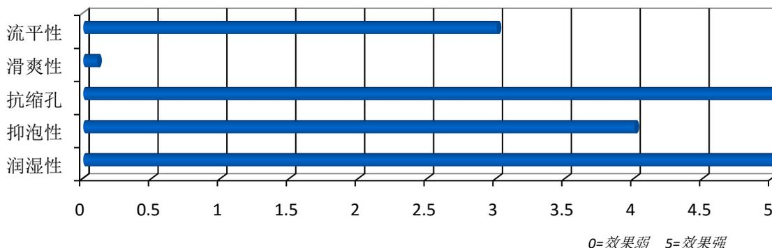
UNIQ®FLOW 487 U 可以用于水性体系/油性体系/UV 体系，具有优异的底材润湿性。此产品不影响层间附着力，可以用于底涂/中涂/面涂。在水性涂料中，可以应用于 PH 4-10 的范围，低稳泡。此产品不会提供滑度和耐划伤性能。
